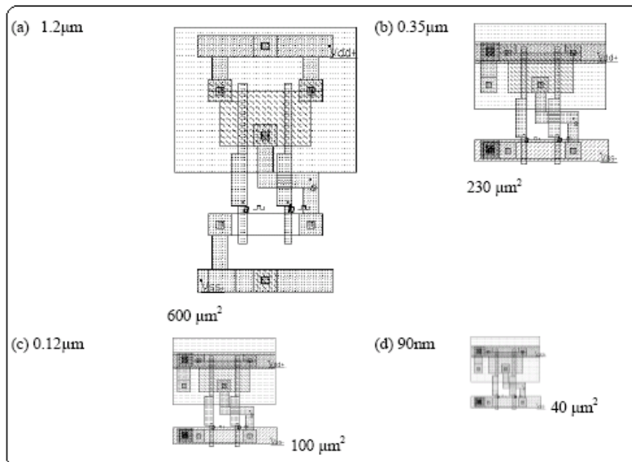
Figura 1.7. Evoluția ariei de Si utilizată pentru implementarea porții NAND.
