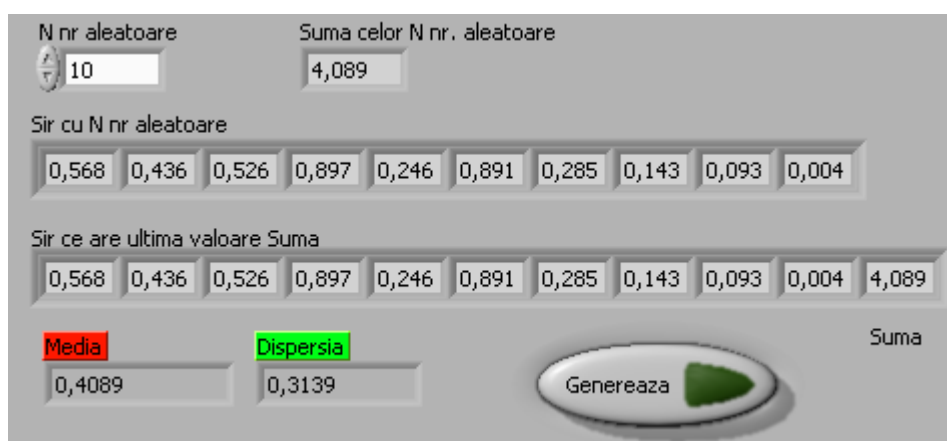
Fig.3.17. Panoul frontal inițial al aplicației Calculul mediei și dispersiei metoda I
