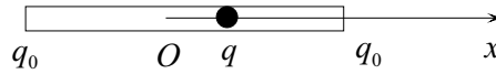
Figura 2.7: Particulă încărcată electric care oscilează într-un tub la capetele căruia se află sarcini de același semn cu cele a particulei
