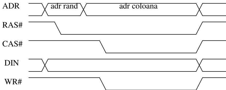
Fig.3.3.13 Citire si scriere la un circuit DRAM.
